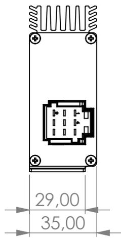
Blechausschnitt für Snap-In Befestigung max. Blechstärke 1,2mm
